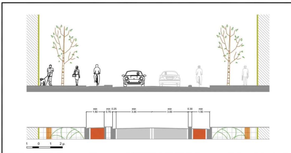
Σχήμα 3-27 Διάδρομος ποδηλάτων μονής κατεύθυνσης | τυπική διατομή
